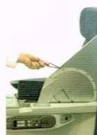
CONSOLA CENTRAL COM MESA DE REFEIÇÕES CENTRAL CONSOLE WITH MEAL TABLE 1. Abre a tampa do apoio de braço 2. Puxe a mesa para cima 3. Rode a mesa para baixo 4. Ajuste para a frente ou para trás 1. Open Armcap 2. Lift table up 3. Rotate table down 4. Fore and aft adjustment
